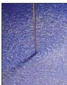
ولدراسة شكل خطوط الفيصل المغناطيسي بالقرب من سلك مستقيم يمر به تيار كهربائي ننشر بعناية كمية من برادة الحديد على سطح لوح أفقي من الورق المقوى يحيط بسلك مستقيم يمر به تيار كهربائي ثابت الشدة ثم نطرق اللوح عدة طرقات خفيفة فنلاحظ أن برادة الحديد تترتب على هيئة دوائر منتظمة متعددة المركز ومركزها السلك المستقيم نفسه كما في الشكل المقابل .
